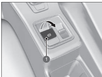
1 Kontakt til elektronisk parkeringsbremse
