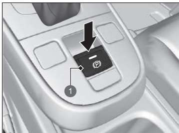
1 Kontakt til elektronisk parkeringsbremse
