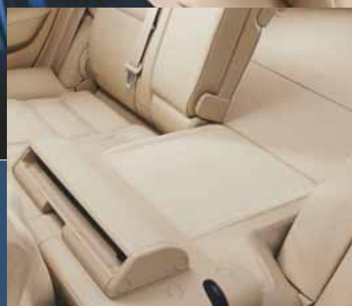
Sædebunden vipper op, samtidig med at ryglænet incl. sikkerhedsselerne trykkes ned. Bagsædet danner et plant gulv, som fuldstændig skjuler nakkestøtten.
