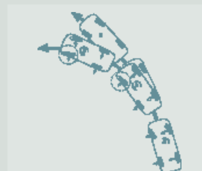
VSA kontrollerer understyring
