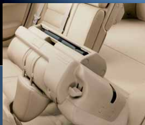
Løsn låsen på siden af bagsædet – så vippes nakkestøtten automatisk ned.
