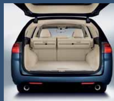
Ryglænet kan klappes helt eller delvist sammen 60/40 alt efter behov. Accord Tourer tilpasser sig efter den last, der skal transporteres.
